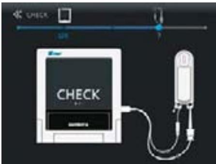
Fig. 33 Tilslutning af fil- + læbeclips til teststik
