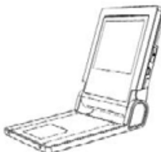
图 1 设备的错误安装
