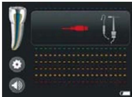
Obr. 6 měřicí kabel ještě není zasunut
