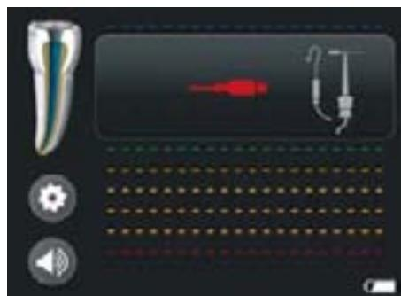
Fig. 6 Mätkabeln är inte inkopplad
