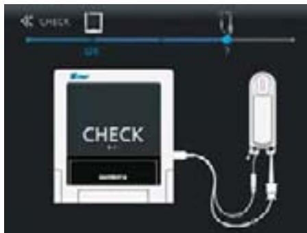
Obr. 33 Připojení klipu pro nástroj a retního háčku k testovacímu konektoru
