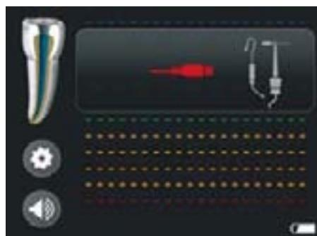
Rys. 6 Kabel pomiarowy nie jest jeszcze wetknięty
