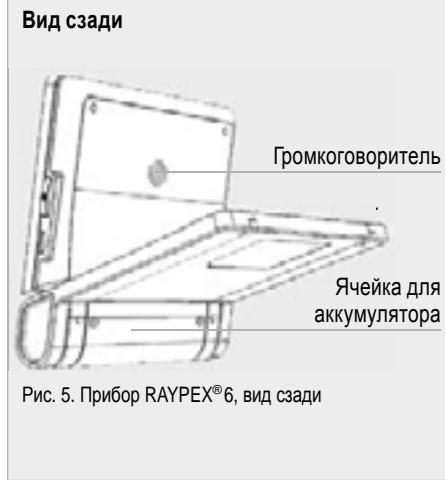
Рис. 5. Прибор RAYPEX® 6, вид сзади
