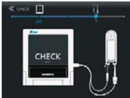
Fig. 33 Ansluta fil- och läppclipset i testkontakten
